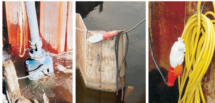
Der NIVA Niveauregler KR1 S kann überall eingesetzt werden, wo Flüssigkeitsstände überwacht werden müssen. Das hochwertige Silikon Kabel ist gegen eine Vielzahl von Medien beständig und kann in Flüssigkeiten bis zu 100°C eingesetzt werden.
