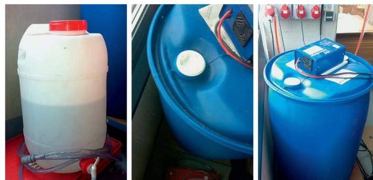
Der NIVA Niveauregler M3 ist speziell für den Einsatz in Verbindung mit Fasspumpen entwickelt worden. Mit einem maximalen Durchmesser von nur 44 mm passt er problemlos durch die gängigsten Spundlöcher. So können einfache Lösungen, z.B. zur Fassentleerung realisiert werden.
