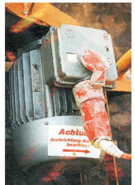
Alle NOLTA Kraft- oder Wendestecker sind mit einem Nockenschalter bestückt, der wahlweise als Betriebs- oder Betriebswendeschalter eingesetzt wird. Der Wendestecker ermöglicht eine einfache Umschaltung der Drehrichtung des Motors, z.B. bei Förderbändern. Optional sind die NOLTA Kraft- und Wendestecker mit einem Phasenwender und einer Drehfeldkontrolle lieferbar.
